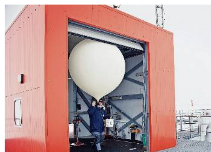
1800 Liter Helium passen in einen Wetterballon. Täglich werden sie am meteorologischen Observatorium mit kleinen Messgeräten, den Radiosonden, gestartet. Sie steigen bis in 35 Kilometer Höhe auf. Die Ballonhalle befindet sich auf dem Stationsdach. Der Kälterekord an Neumayer liegt bei minus 50,2 Grad Celsius, gemessen im antarktischen Winter am 8. Juli 2010. Foto: Steuer/AWI
